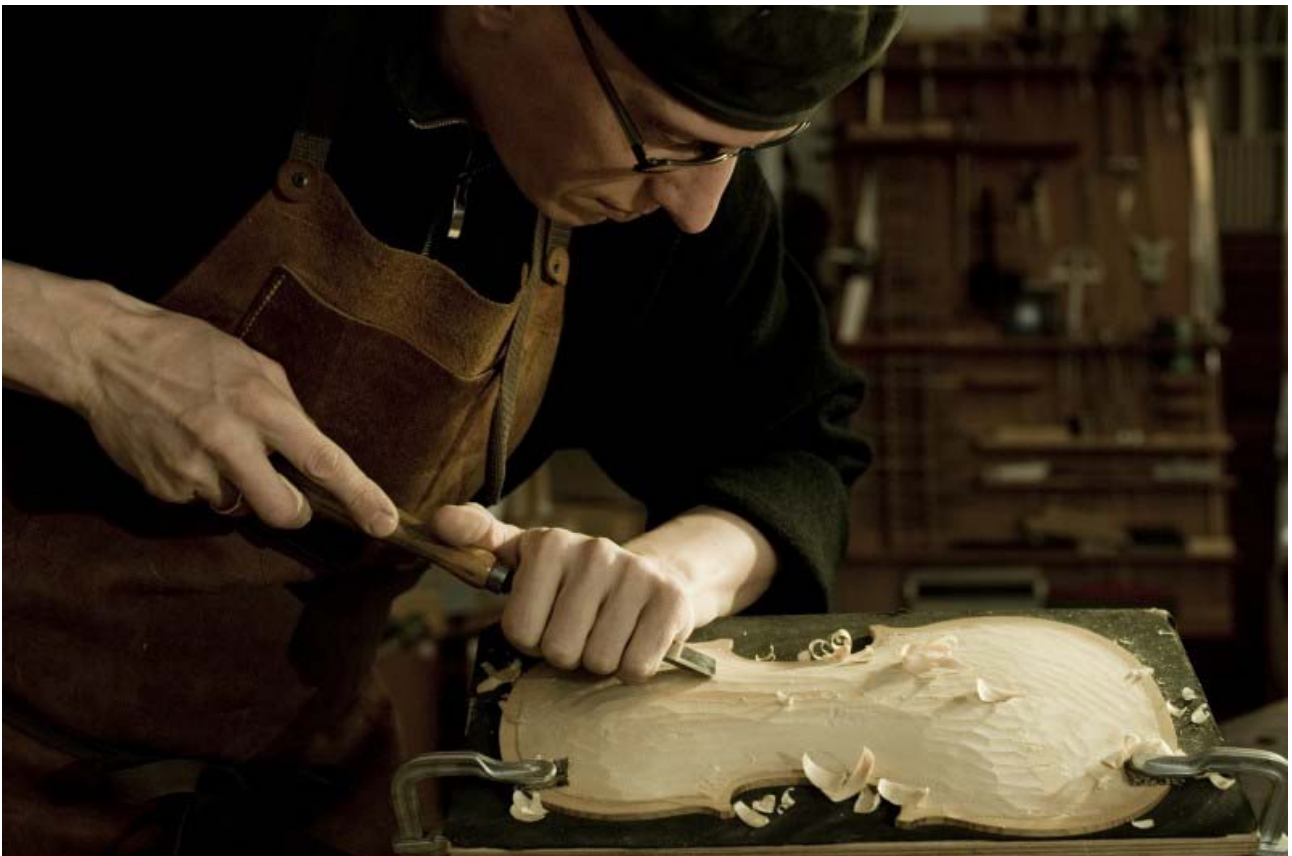
Martin Schleske beim Herausarbeiten der Wölbung in seiner Werkstatt in Landshut am Lech
